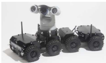
R 4075 A con opción cámara PTZ (color/visión nocturna) montada
