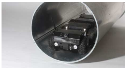
ARTHRON R 4075 A puede inspeccionar canalizaciones a partir de un diámetro de 350mm
