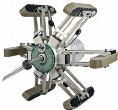
Robot de nettoyage (configuration de base pour conduits ronds)
