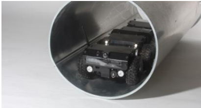
ARTHRON R 4075 A peut inspecter des canalisations à partir du diamètre 350 mm.
