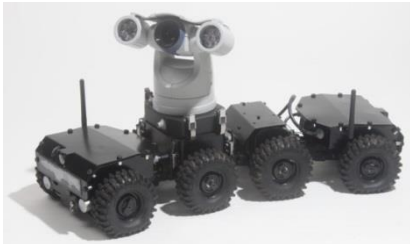
R 4075 A avec sa caméra PTZ optionnelle (couleur / vision de nuit) montée
